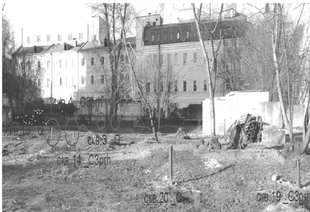
Рис. 2 Оборудованная сеть режимных скважин (Садовническая наб., вл. 3-7). Май 2014 г.
